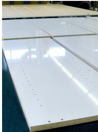
▲ Nach dem Entfernen der Randstreifen liegen die fertigen Werkstücke bereit zum Abräumen.
